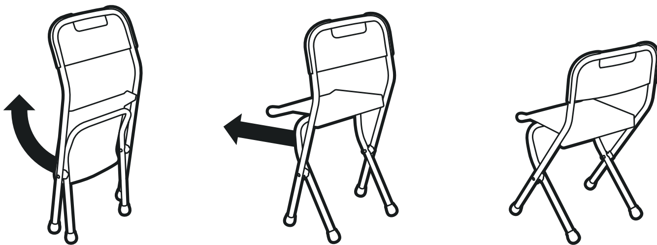
Рис.3 Схема раскладывания стула с пластиковым спинкой и сиденьем.
