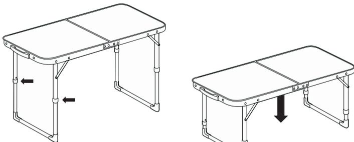
Рис. 4 Регулировка высоты стола
